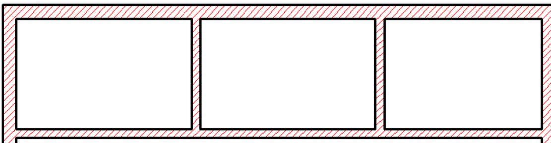
Kopieren Sie nun die waagerechte Zwischenwand um 1.74 Meter nach unten, um einen Flur von 1.5 Metern Breite zu erhalten.
